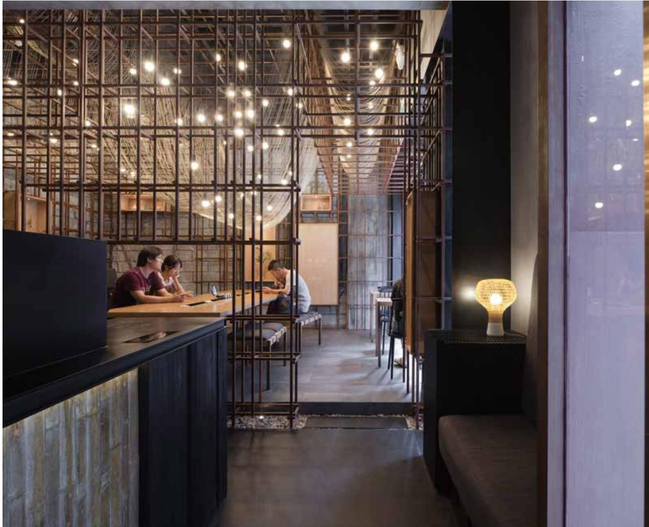
从左侧盒子进入店内，首先来到一个简约内敛的空间：前台嵌缀着曾用于浇筑混凝土的竹模，与外立面相呼应，水泥素墙衬托着由橡木盒子和点单屏幕组成的背景墙。转身步入用餐区，围绕着铁架子的光晕将空间的丰富层次展开：墙体原本的砖块与水泥结构得以露出，与铁架子共同营造粗犷的背景。
